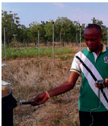
e. Mesurer la température à l'aide d'un thermocouple de type k-type thermocouple
